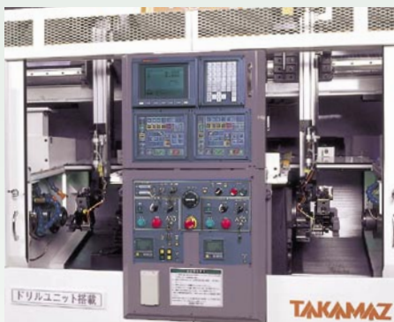
振動伝導率を極力抑えた 2スピンドル2タレット構造 2-spindle/2-turret structure for minimizing vibration conductivity
