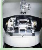
■主軸(Y, Z)を機械後方に30度傾斜させたスラント 構造。
